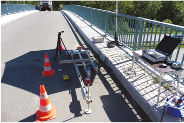
Bild 2 Messaufbau im Zuge des horizontalen Belastungsversuchs Measurement setup during the horizontal load test
