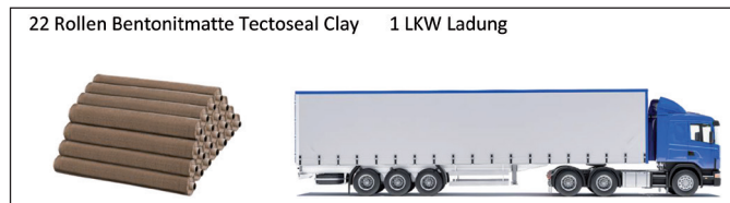
Bild 2 Transportbedarf für 4.500 m 2 mit geotextiler Bentonitmatte
